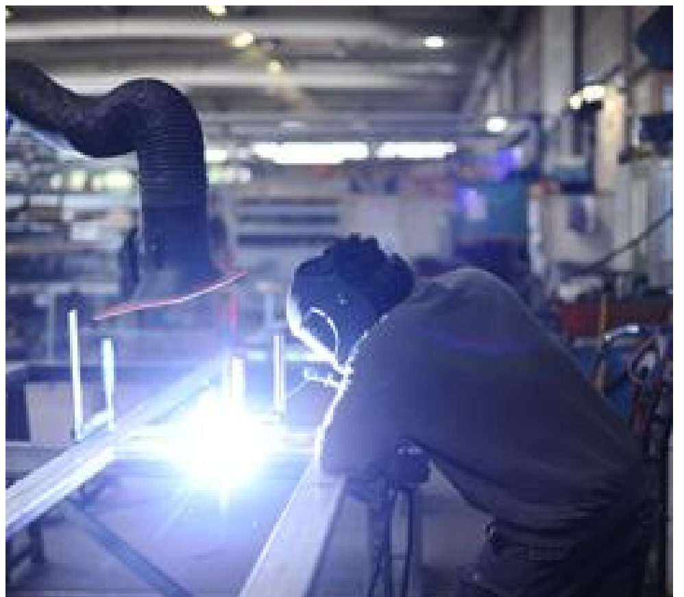
Schweißarbeiten an Unterkonstruktionen in der Schlosserei
